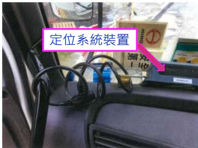
所有泥頭車配備全球衛星定位系統
